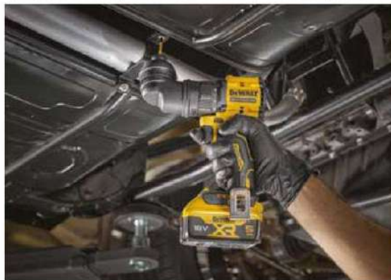
DeWalt DCD903 è un trapano avvitatore multistadio 18V XR Brushless compatto e versatile, progettato per lavorare anche negli spazi più difficili. Dotato di 15 punti di regolazione frizione, velocità a vuoto fino a 1.650 giri/min e coppie massima 73Nm, offre quattro attacchi intercambiabili per foratura e avvitatura professionale.
